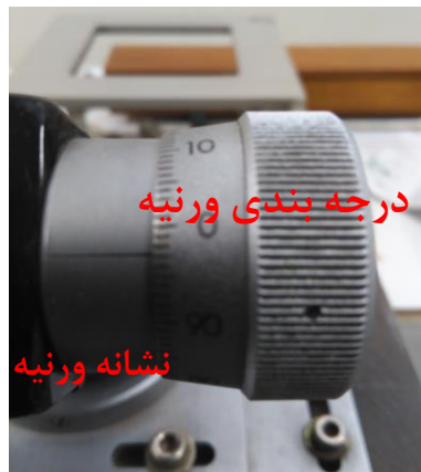
شکل ۳۰- قرائت عدد ورنیه معادل ۹۷ میکرومتر
