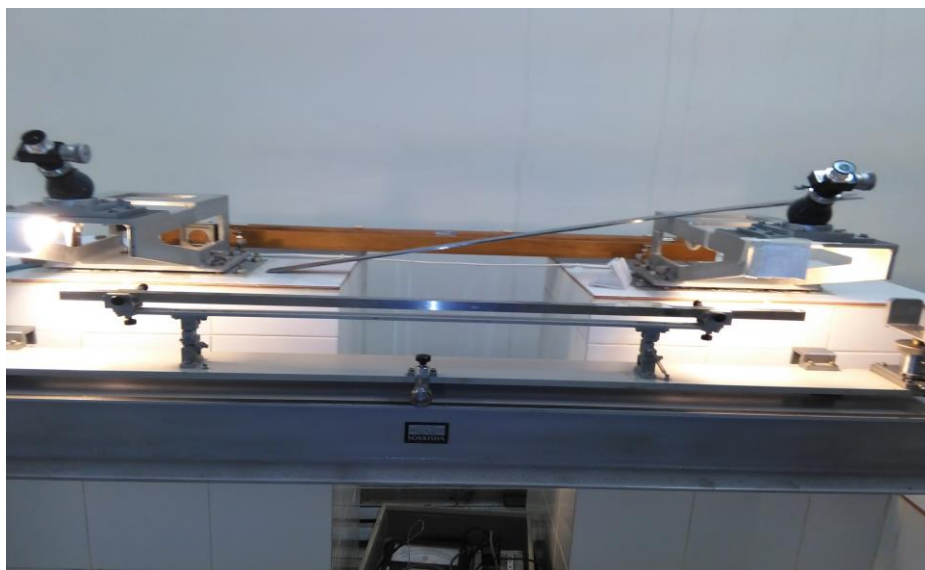
شکل ۸- متر استاندارد در زیر دستگاه کالیبراسیون
