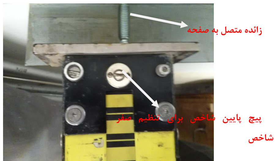
شکل ۳- نمایی از پیچ تنظیم صفر
