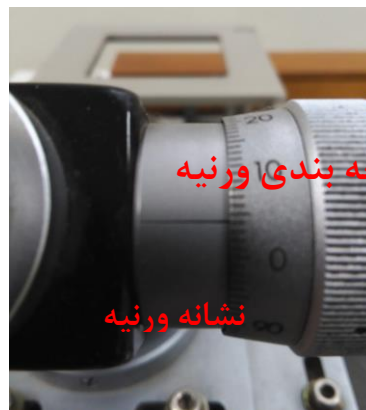
شکل ۳۱- قرائت عدد ورنیه معادل ۴ میکرومتر
