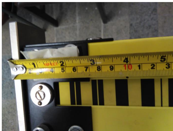
شکل ۴۵- علامت‌گذاری بدنه شاخص انوار بارکدی
