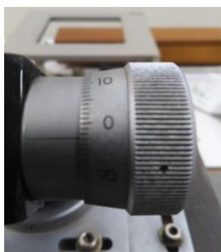
شکل ۳۷- قرائت عدد ورنیه معادل ۹۷ میکرومتر
