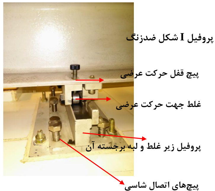
شکل ۱۱- صفحه و پیچ‌های اتصالی شاسی زیرین به ستونک سمت راستی دستگاه، غلتک و پیچ قفل حرکت عرضی شاسی
